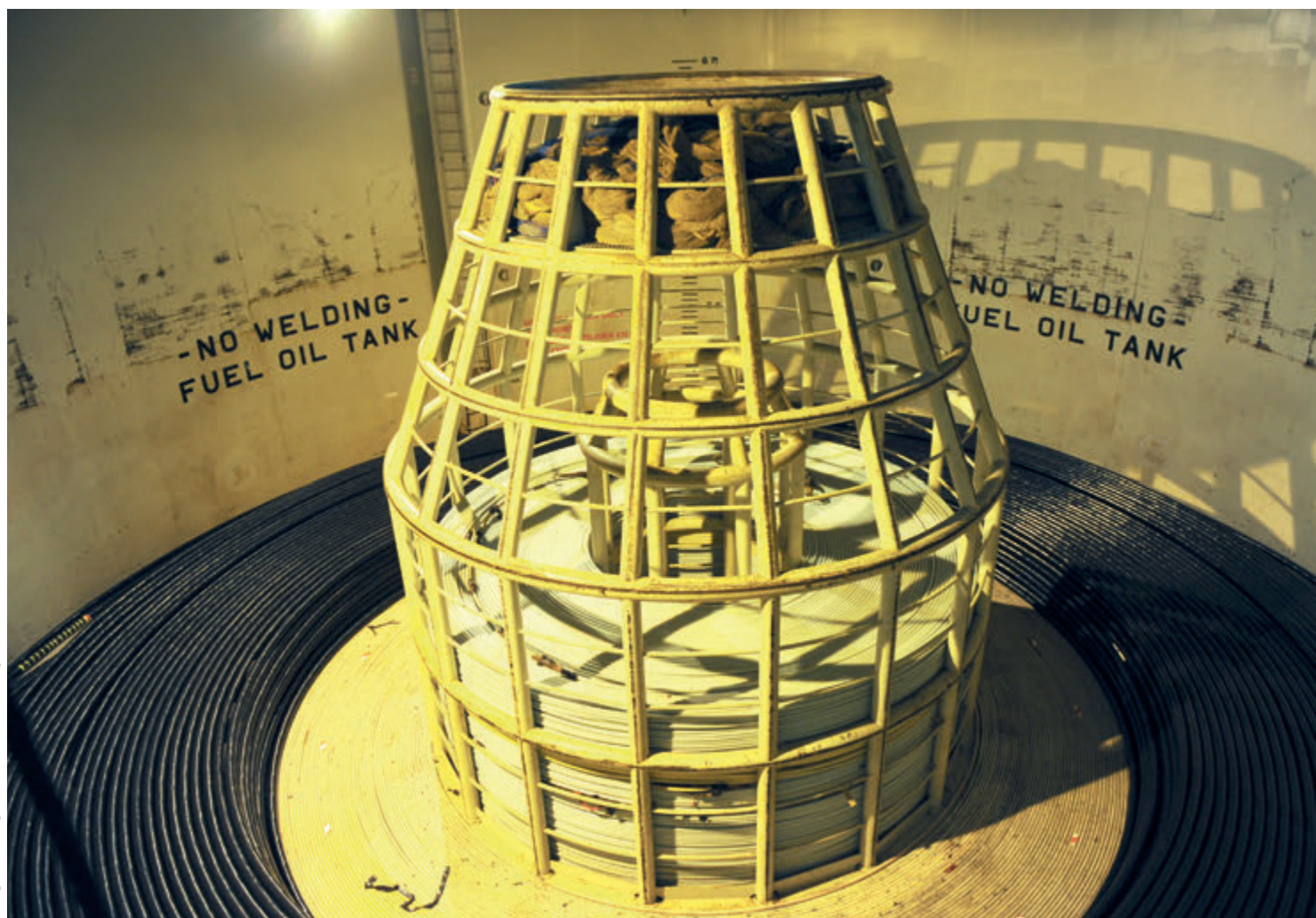
Le bateau René Descartes lors de la pose du câble de 8 MW de la SEM-REV au large du Croisic, mai 2012.
